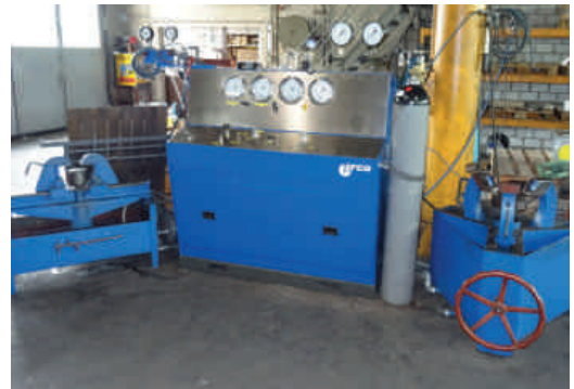
Prüfen auf Dichtheit und Funktion auf unseren Prüfständen Vérification de l'étanchéité et de la fonction sur nos bancs d'essais
